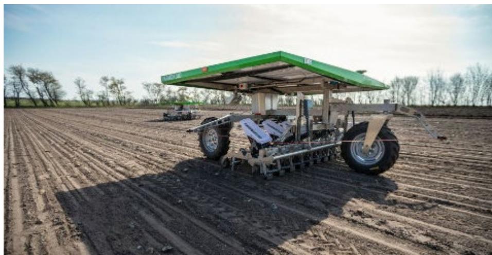
太陽光発電により播種と防除を可能にするFarmdroid FD20
