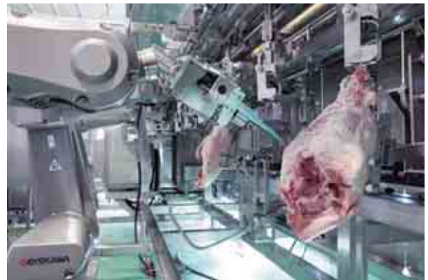
写真2 ロボットアーム、エンドエフェクタ、ナイフ (写真：前川製作所提供)
