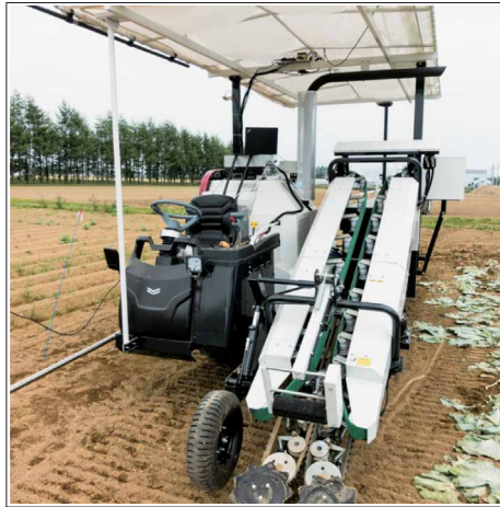
キャベツ自動収穫ロボット (写真：立命館大学理工学部深尾教授提供)
